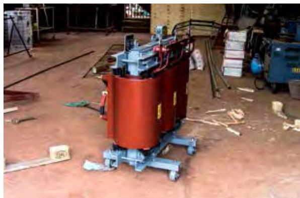
1. Trasformatore nuovo di alta tensione
